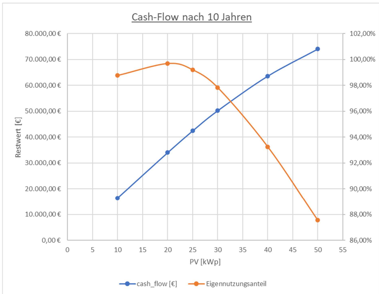
Abb. 16: Optimierung der PV-Anlage auf Eigennutzung
